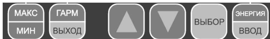
1. Кнопка **МАКС/МИН**- включает режим отображения максимальных и минимальных значений. При повторном нажатии возврат в общую группу измерений.
